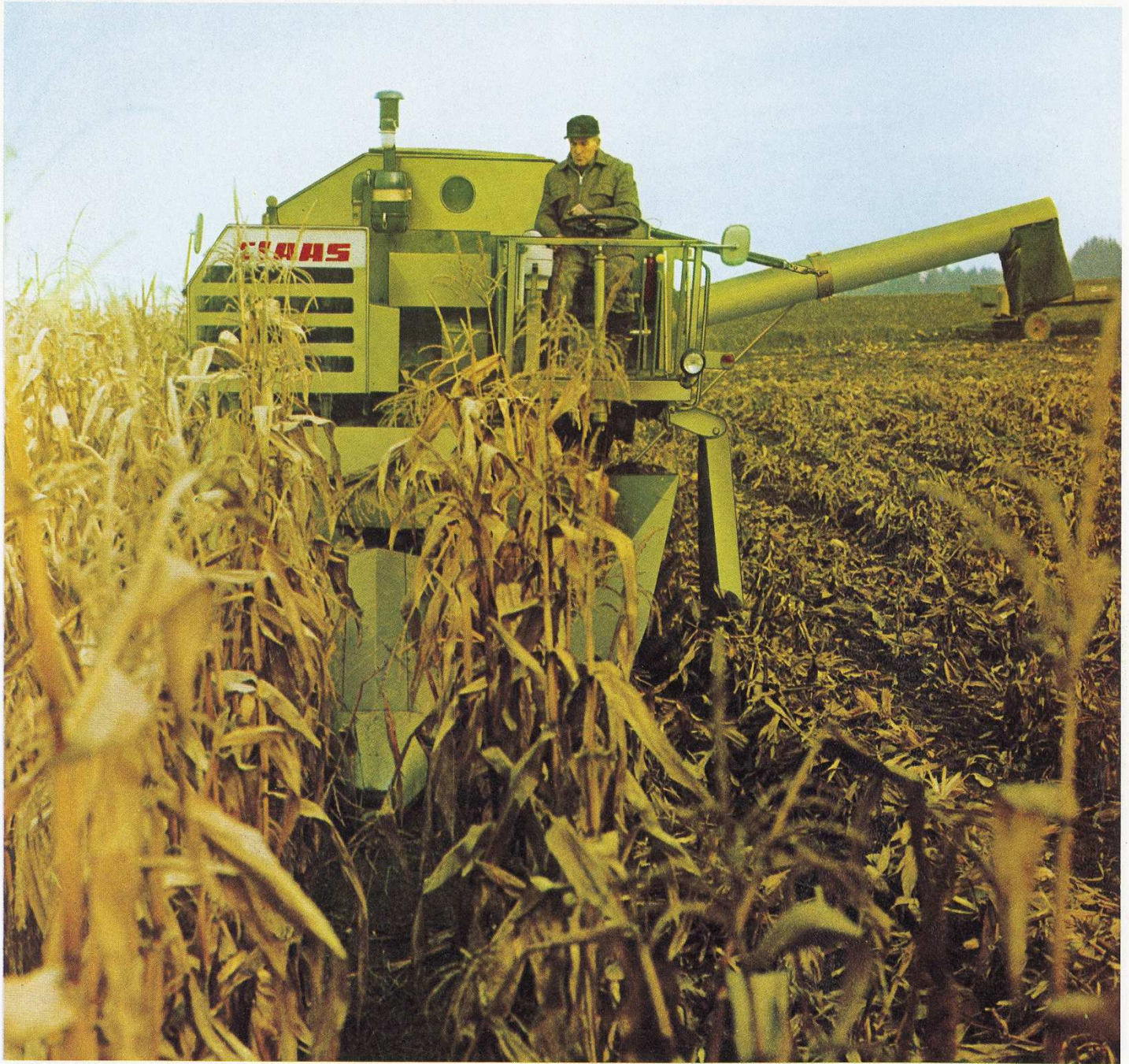
Auch Körnermais kann mit dem CLAAS-CONSUL (hier mit zweireihigem Maispflückvorsatz) arbeitssparend geerntet werden.
